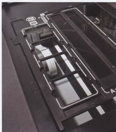
Рамка для монтажа 35-миллиметровых фотопленок, установленная на планшете
